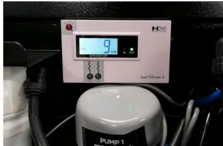
2) De tweede TDS-meter is bevestigd op de voorzijde van het kastje van Smartank®. Deze bewaakt de puurheid van het water van beide DI-filters (gebruiker 1/gebruiker 2). Als de waarde voor omgekeerde osmose water hoger is dan 5 ppm, dan is vervanging van het DI-filter nodig.
