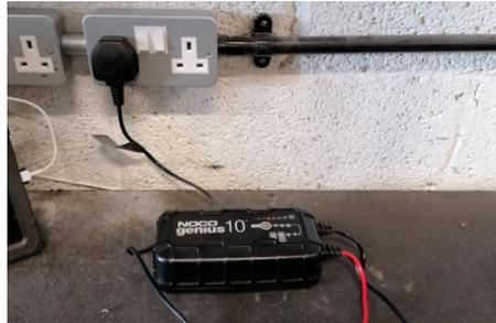
ii. Insérez la prise du chargeur dans la prise de charge bleue et allumez le chargeur.
